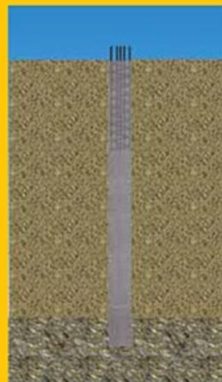
Pilotes barrenados. Hormigonado por el tubo central de la barrena. La perforación se realiza mediante la introducción de la barrena helicoidal de la misma longitud que la perforación a realizar. Sustituye con ventaja el sistema de perforación con lodos bentoníticos cuando los diámetros de los pilotes no son superiores a 1000 mm.
